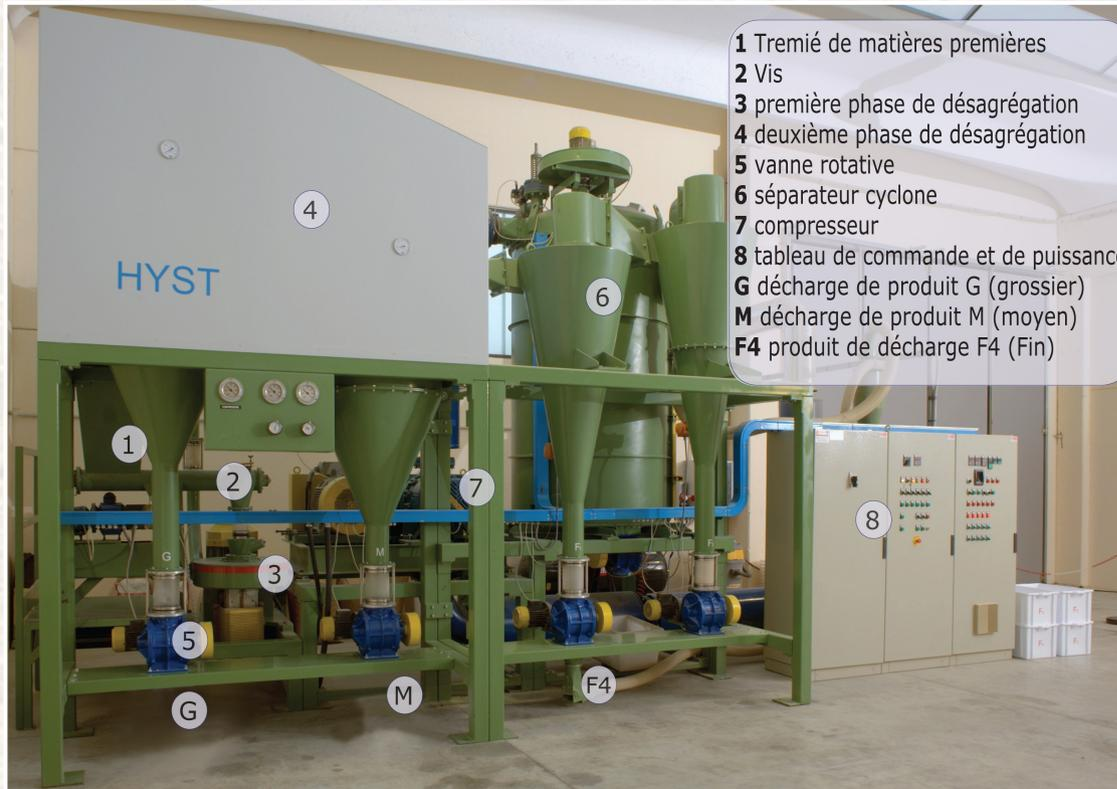
Le système Hyst est conçu pour transformer à travers un procédé physique les matériels végétaux. Il est constitué par deux composants principaux: les désagrégateurs (3, 4) et les séparateurs (G, M, F4, 6).
