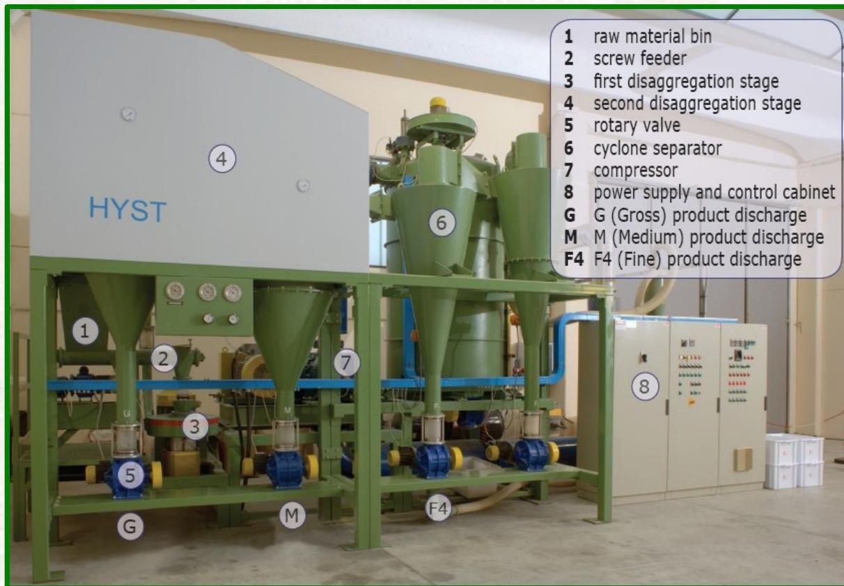
Dispositivo industriale (capacità 1-5 t/h)
